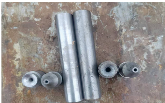
图3 水力射流泵喷嘴未冲蚀(左侧)与冲蚀(右侧)
